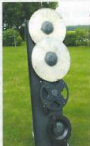
Côté élagage, Kuhn propose, au travers d'un partenariat avec Coup'Eco, des lamiers équipés de scies (haut), de plateaux simples à quatre couteaux (milieu) ou de plateaux renforcés à deux couteaux (bas).
