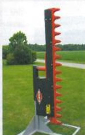
Plus polyvalents, les sécateurs nécessitent moins d'entretien que les lamiers mais affichent des débits de chantier inférieurs (2 km/h max contre 3 à 4 km/h avec un lamier).
