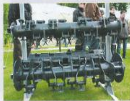
Le rotor mixte (haut), uniquement proposé sur les modèles de 44 ch et, enfin, le nouveau rotor débroussaillier (bas), disponibles sur les machines de 51 et 57 ch, qui représente un bon compromis pour les broussailles et le bois (jusqu'à 7 cm).
